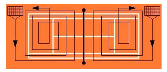
Sollten sich im Schleppnetz außer Sand, auch Äste, Laub oder andere Fremdkörper befinden, bringt es nichts diese über den ganzen Platz zu ziehen. Die Fremdkörper, die sich unter dem Schleppnetz befinden, müsst Ihr entfernen. Denn nur wenn das Schleppnetz komplett aufliegt, bekommt man eine glatte, saubere Platzoberfläche.
